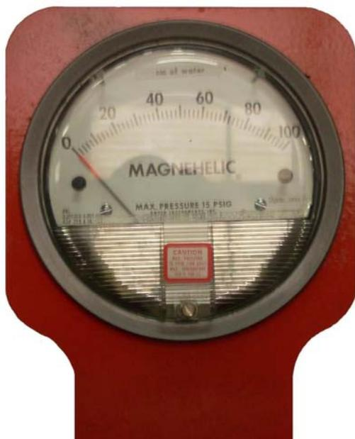
Le vacuomètre est un instrument pour mesurer la dépression.
