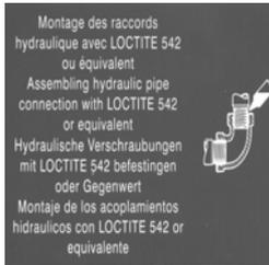
Montage des raccords hydrauliques avec de la loctite 542 ou équivalent.
