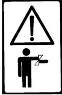
Attention zone dangereuse en particulier lors des phases d'ouverture et fermeture. Zone d'articulation avec risque de sectionnement.
