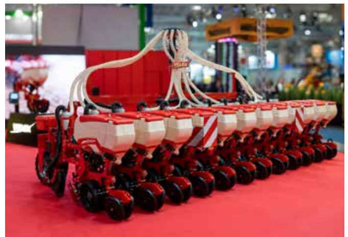
* Cabezal de distribución con tubos de fertilizante
