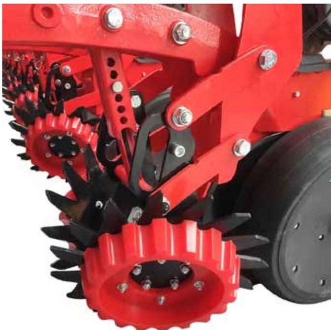
\* Étoiles de nettoyage avec anneaux de contrôle
