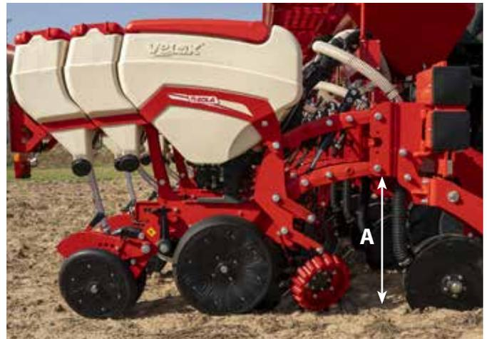
1. Une fois la machine couplée au tracteur, laissez-la reposer légèrement sur le sol, de manière à ce que les roues de support entrent en contact avec le sol sans poids.
