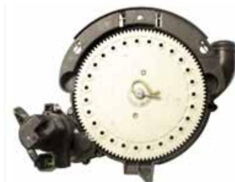
5. La dernière étape de l'installation du kit de cultivateur consiste à placer le singulateur dans le boîtier du metering. Insérez d'abord la base du singulateur dans le clip inférieur, puis appuyez sur le clip supérieur. Veillez à ce que les côtés supérieur et inférieur du singulateur soient alignés avec les languettes à ressort. Vous devez vous assurer que le singulateur est bien en place pour garantir une connexion correcte du metering lors de l'assemblage du couvercle et du boîtier.
