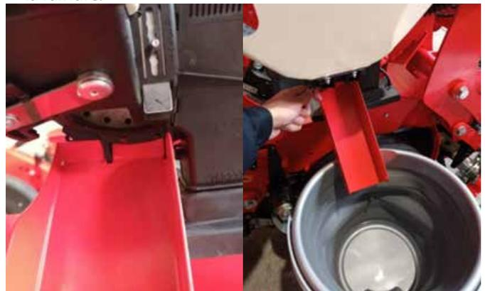
2. Le canal étant en place, ouvrir le clapet de vidange en le tirant légèrement et en le tournant vers la gauche. Ne pas trop écarter le clapet car cela pourrait déformer le ressort de fermeture et entraîner une mauvaise fermeture du clapet.
