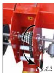
3- Установить цепь на зубчатое колесо, выбранное по вышеуказанной таблице. Группа из 3 зубчатых колес обозначается буквами А-В-С, а группа из 6 зубчатых колес обозначается цифрами 1-2-3-4-5-6.
