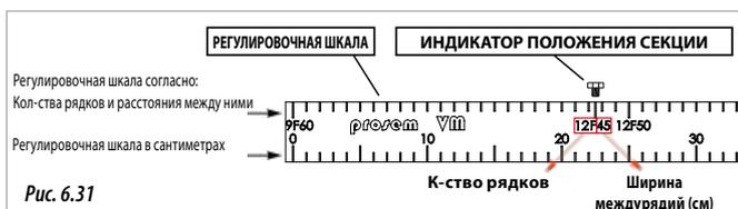
Высевающие секции сеялки с телескопической рамой, находящиеся по центру, жестко прикреплены к раме. Боковые высевающие секции являются подвижными и в зависимости от модели рамы могут регулироваться:
