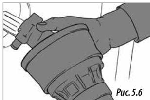
шлицевыми хвостовиками трактора и сеялки, нажимая при этом на предохранительный штифт. Отпустить штифт и отвести карданный вал назад до щелчка, который указывает, что штифт стал на свое место.
