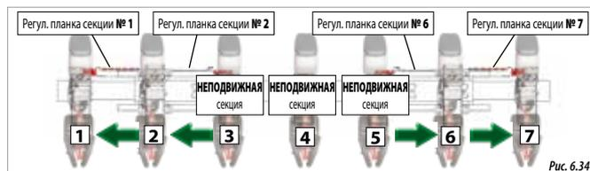
Регулировка расстояния между рядами с обеих сторон выполняется с помощью ограничителей открывания на регулировочных планках (А, рис. 6.35).
