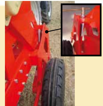
-ARTICULACIÓN REGULABLE PARA EL CONTROL DE PROFUNDIDAD.
