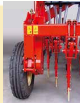
-VISTA FRONTAL DEL BRAZO DE SIEMBRA Y EL CONTROL DE PROFUNDIDAD.
