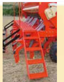
-ESCALERA Y PLATAFORMA DE SERVICIO.
