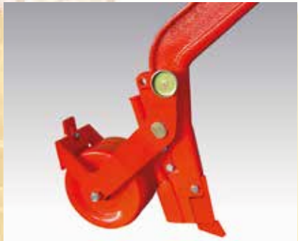
-BRAZO DE SIEMBRA CON CONTROL DE PROFUNDIDAD INDEPENDIENTE, REJA INTERCAMBIABLE, CON PUNTA ANTIDESGASTE.
