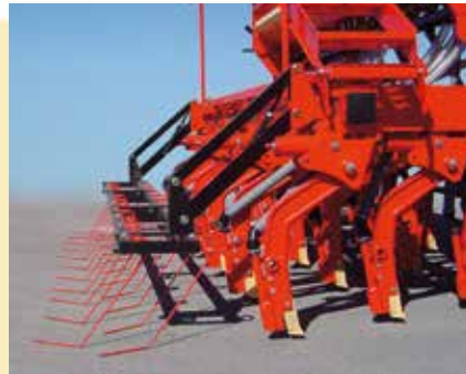
-VISTA LATERAL DEL BRAZO DE SIEMBRA. RASTRA DE PÚAS FLEXIBLES EN "L".
