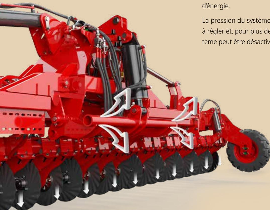
Lorsqu'il est activé, un vérin hydraulique transfère le poids du tracteur au châssis du semoir, ce qui permet de maintenir en permanence la force d'appui requise. Cela garantit un placement optimal des semences sans augmenter le compactage du sol ni la consommation d'énergie.
