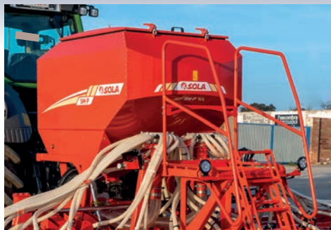
Trémie pressurisée de 2000 litres de capacité.
