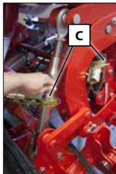
Después de la regulación, guardar el trinquete hacia el interior de la máquina y bloquear su posición con el pasador (C).
