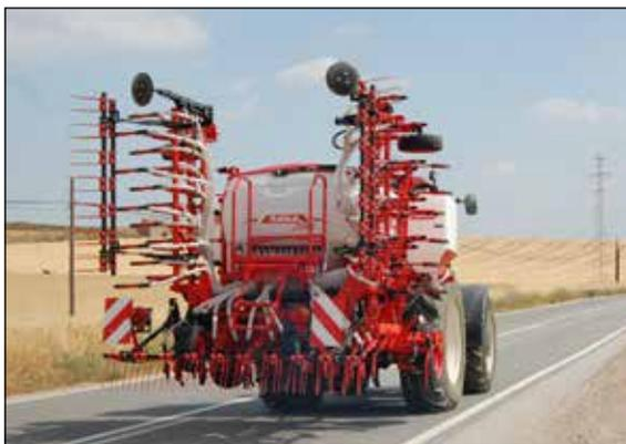
Comprobar el correcto funcionamiento de las LUCES DE SEÑALIZACIÓN.
