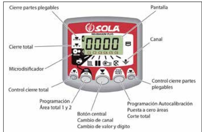
El monitor sale de fábrica programado para la sembradora en la que está montado. Por lo tanto solo debe visualizar los valores y no hace falta entrar en programación.
