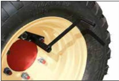
7- A continuación, coloque la manivela en la rueda derecha de la sembradora.
