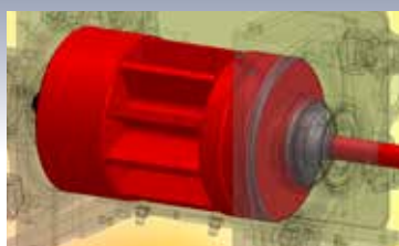
Distribuidor volumétrico con accionamiento eléctrico de rodillos modulares intercambiables.
