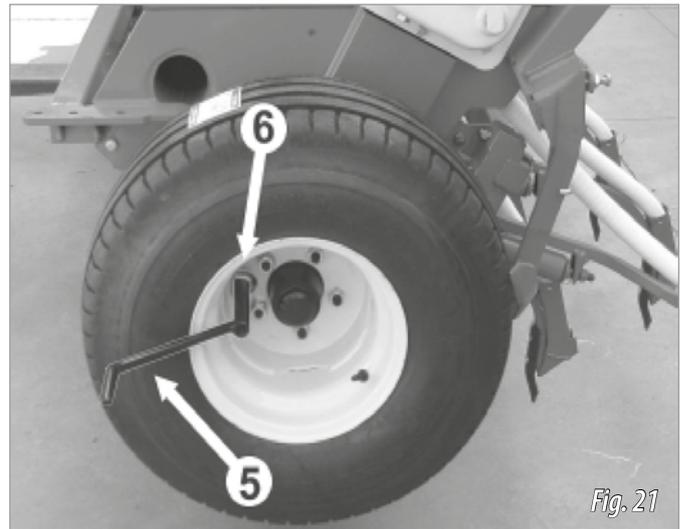
TERCERO: se enclava la palanca (5, fig. 21) en el alojamiento (6, fig. 21) de la rueda izquierda y se dan algunas vueltas a la rueda hasta que el fertilizante empiece a caer. La máquina TRI-294/R-ESP se suministra sin la palanca, por lo que deberá dar las vueltas manualmente. Se retira el fertilizante y se empieza a dar las vuelta según el cuadro siguiente:
