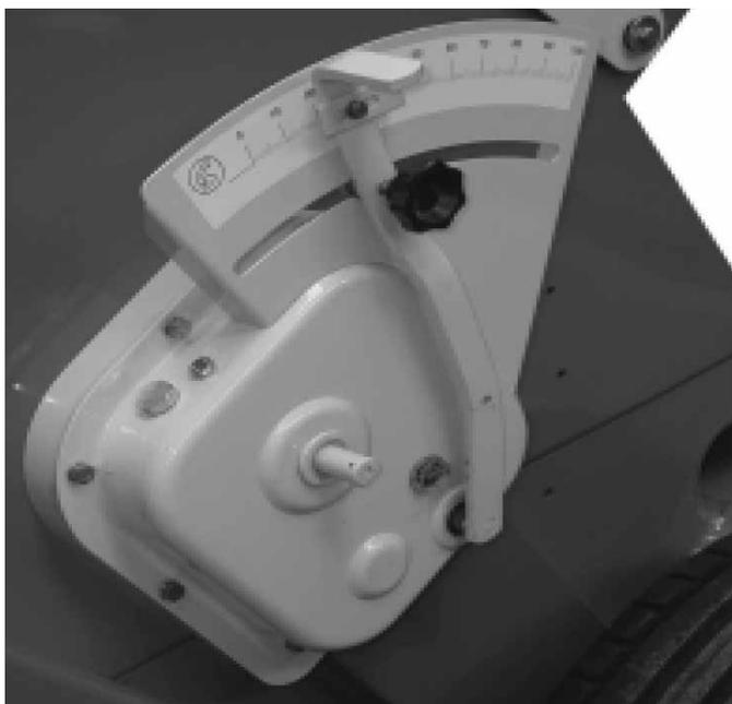
Finalmente, se suelta el pomo del variador, se desplaza la palanca sobre el sector graduado del 0 al 100 y se fija nuevamente sobre el número que previamente se habrá seleccionado (fig.12) guiándose con las tablas de las pgs. 38-41.
