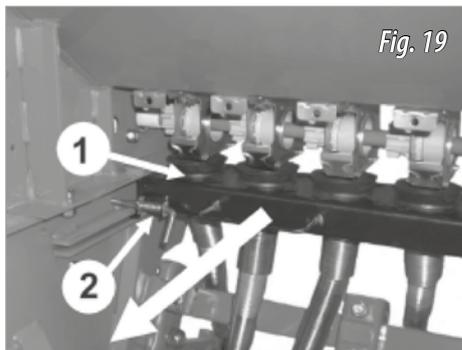
PRIMERO: deslizar la barra portaboquillas (1, fig. 19) hacia delante, soltando los gatillos (2, fig. 19) que la mantienen en su posición de trabajo, hasta la posición para colocar la bandeja.
