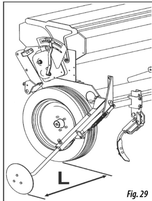
Los brazos de los trazadores son extensibles para su ajuste en longitud y los discos pueden orientarse para darles el ángulo de penetración adecuado. Además, en la ejecución hidráulica, se ha dispuesto unos muelles complementarios que permiten regular la presión del disco sobre el terreno. Para calcular la distancia entre el disco y el exterior de la rueda (L, fig. 29) debe aplicarse la siguiente fórmula:
