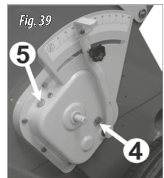
Controlar el nivel de aceite del variador a través de la mirilla (4, fig. 39) y si es necesario completar con aceite SAE 30 por el tapón (5, fig. 39)
