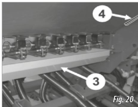
SEGUNDO: se retira la bandeja (3, fig. 20) de su asiento de transporte (4, fig. 20) y se desliza horizontalmente debajo de los dosificadores. La máquina TRI-294/R-ESP no dispone de bandeja, por lo que en su lugar deberá usar un plástico.
