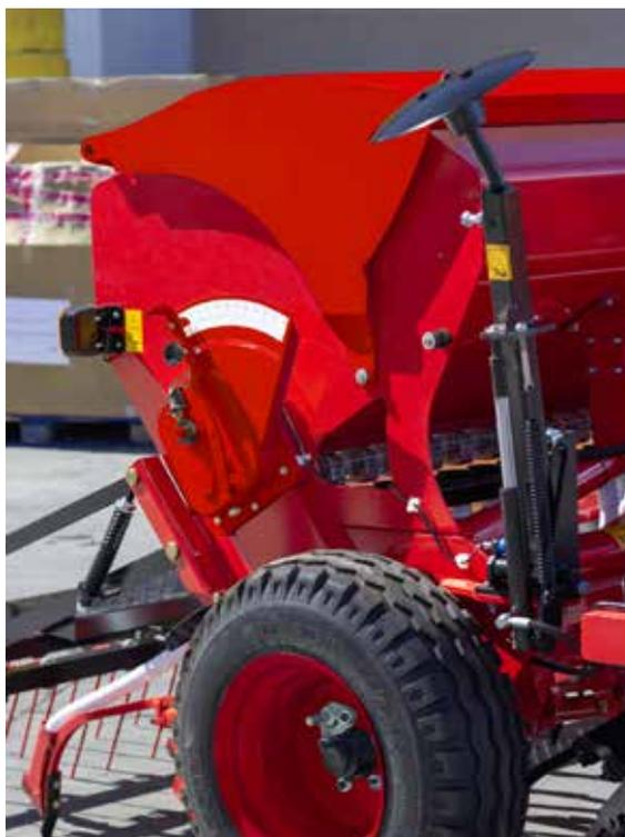
Para el transporte de la máquina por la vía pública es imprescindible llevar ambos trazadores en posición vertical, fijados con la clavija de anilla para evitar su posible descenso durante el trayecto
