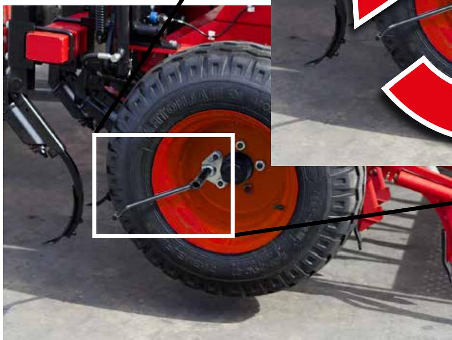
El peso de fertilizante recogido, multiplicado por 40, son los kilogramos de fertilizante por hectárea que repartirá la máquina con la palanca en el sector previamente escogido. Es muy recomendable efectuar una prueba de precisión con el fertilizante a utilizar para comprobar el nivel de fiabilidad de la tabla de dosificación.
