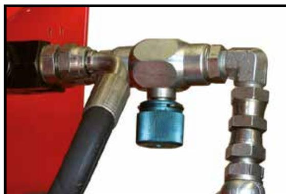
**Position des vannes pour l'OUVERTURE et la FERMETURE des ailes.**
