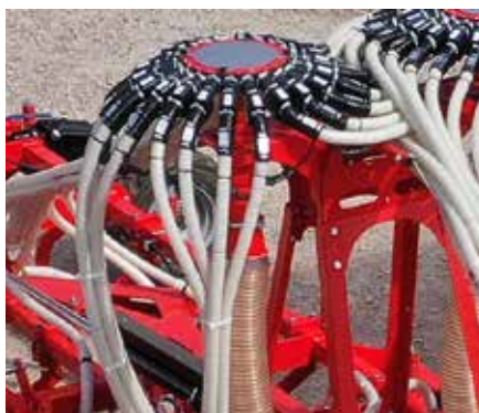
Cellules de contrôle du débit
