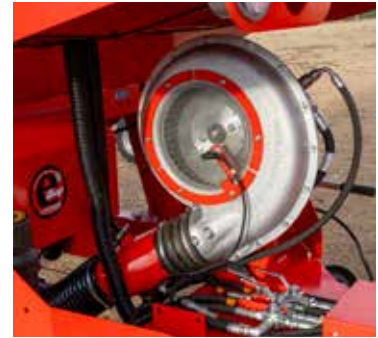
Turbine à entraînement hydraulique à haut rendement.
