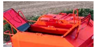
Ouvertures de chargement à fermeture hermétique avec couvercles ronds ou rectangulaires
