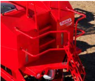
Échelle d'accès à la plate-forme. Fenêtres de contrôle.
