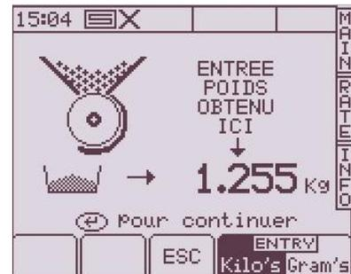
5. Presser VALIDER encore une fois, et la console re-calcule et affiche le nouveau facteur de CALIBRAGE en kg/rev, le % d'erreur, et la vitesse d'avancement maximale permise calculée en fonction de la dose d'application réglée pour le produit (fig.15).
