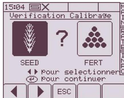
**NOTE:** *Si vous calibrez un système avec un simple moteur et deux doseurs, veiller à ce que le produit ramassé, pesé et programmé vient des DEUX doseurs.*
