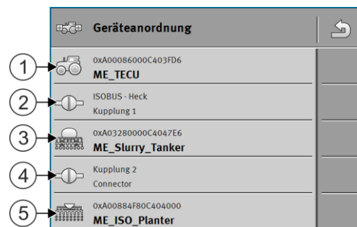
Beispiel für eine Geräteanordnung in ISOBUS-TC mit Güllewagen und Einzelkornsämaschine
