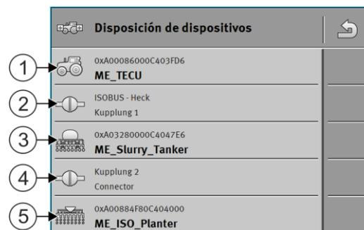
Ejemplo de una disposición de dispositivos en ISOBUS-TC con sistema y sembradora de precisión
