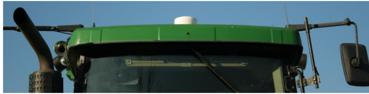
Receptor GPS sobre el techo de un tractor
