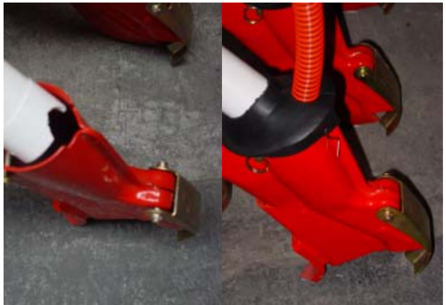
Fig. 20 - Sembradora EURO: recortar el tubo telescópico, soldar el suplemento, taladrar el tapabotas y montar el conjunto.
