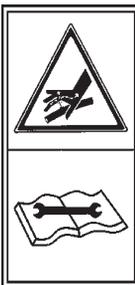
Posibilidad de penetración de fluido hidráulico a presión. Mantenga en buen estado las conducciones. **Peligro de lesiones graves.**
