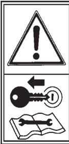
Pare el motor del tractor y evite que se arranque durante los trabajos de mantenimiento o reparación de la abonadora.
