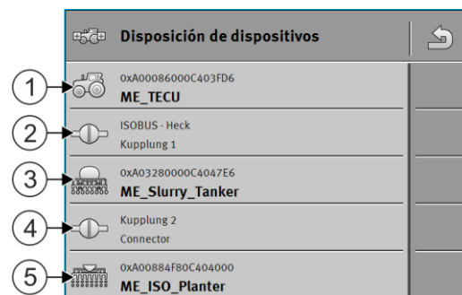
Exemple de disposition des appareils dans ISOBUS-TC avec les tonnes à lisier et les semoirs monograine
