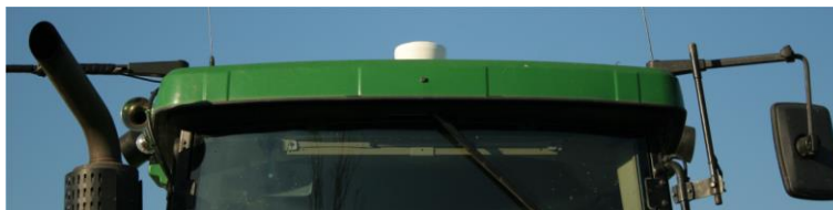
GPS-приёмник на крыше трактора
