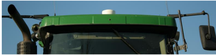
Récepteur GPS sur le toit d'un tracteur
