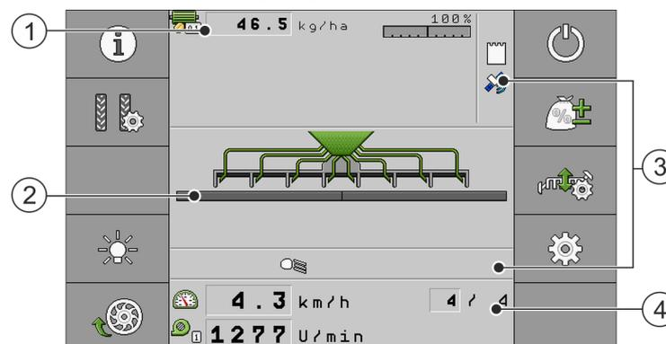
Arbeitsmaske bei einer Sämaschine
