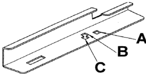
Vue d'une palette gauche (doit se fixer dans le disque du côté gauche en sens de la marche)
