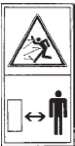
Опасность попадания гранул удобрений при разбрасывании. Держаться на расстоянии от разбрасывателя удобрений при работе.
