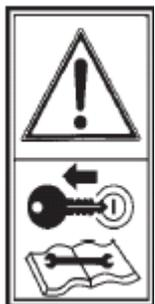
Остановить двигатель трактора и не запускать его до тех пор, пока будут продолжаться работы по техническому обслуживанию и ремонту разбрасывателя удобрений.
