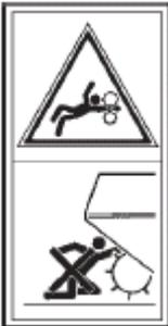
Риск серьезного травматизма при столкновении или контакте с движущимися частями разбрасывателя (диск и лопасти).
