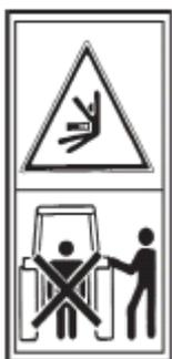
Следует находиться на безопасном расстоянии от задней части трактора при маневрировании с разбрасывателем удобрений. **Риск серьезного травматизма.**
