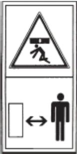
Опасность придавливания. При работе под машиной необходимо убедиться, что приняты все меры безопасности и что отсутствует опасность придавливания. **Риск серьезного травматизма.**
