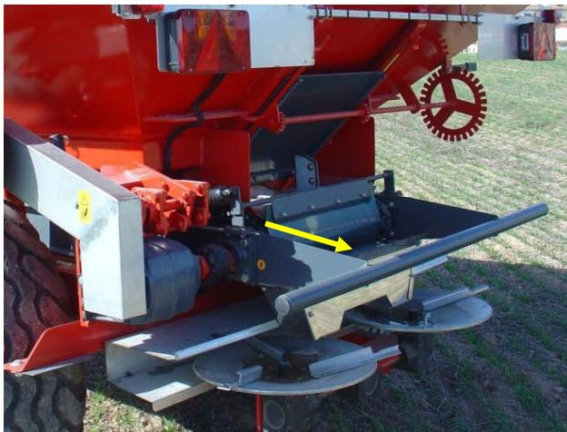
Вытащить дозирующую емкость, один раз отсоединивши всё, вытащить назад ленточную тележку.
