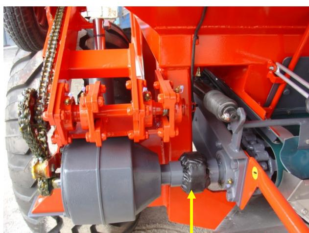
Снять защиту и отсоединить цепи соединения.
