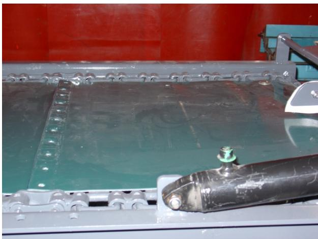
Прокрутить ленту и соединить её с вверху другой на поперечине(если длинная то отрезать),просверлить,соединить болтами,отпустить натянутую цепь.
