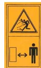
Опасность придавливания. Держаться в стороне от задней части трактора при манёврах прицепления разбрасывателя.
