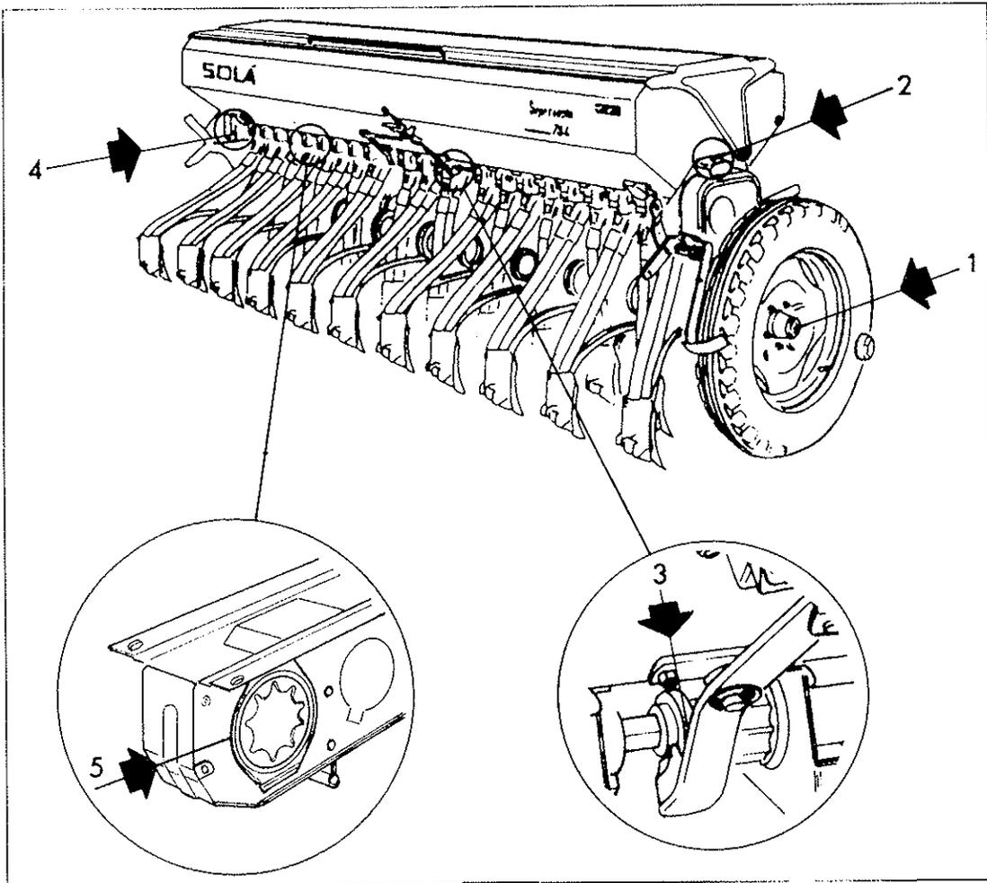
En las COMBINADAS es conveniente engrasar con gasoil las ranuras donde giran las arandelas estriadas inoxidable de la zona del abono, en la parte exterior de los distribuidores.
