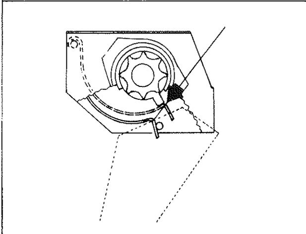
Forzando el fondo móvil del distribuidor hacia abajo y colocando el clip de amarre de la boquilla frente a la pestaña de dicho fondo se aumenta notablemente la profundidad de paso, posibilitando la siembra de habas, garbanzos, etc. que por su tamaño no las admitiría un distribuidor normal.
