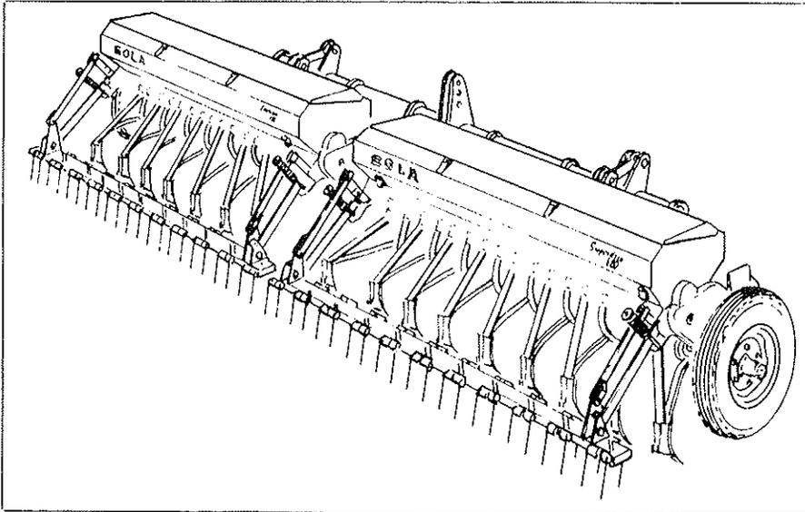
Una ARTICULADA es el conjunto de dos máquinas normales unidas en su parte delantera mediante un SUPER CHASIS tubular provisto de triple articulación y enganche tripuntal al elevador del tractor.
