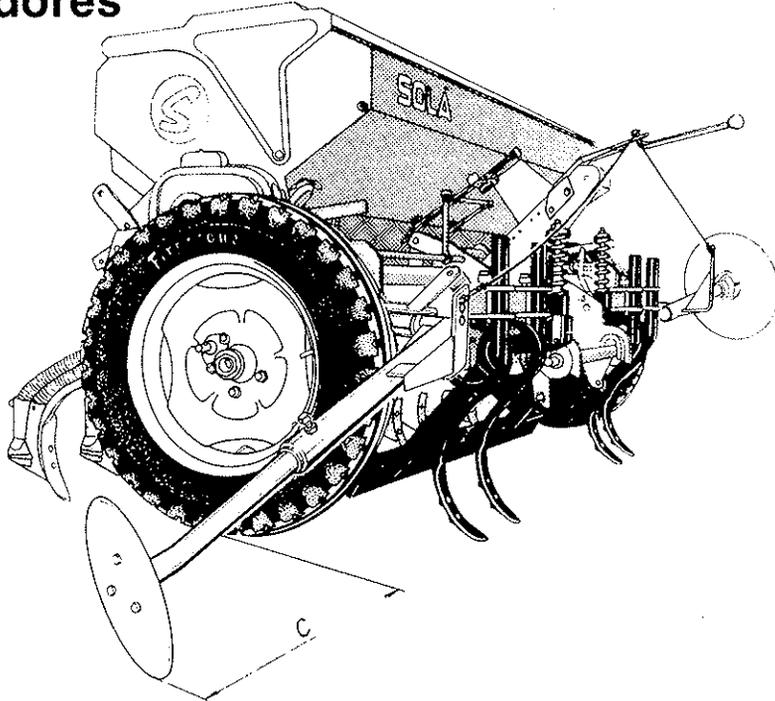
De construcción robusta, con discos cóncavos de 13" , se acoplan a todas las medidas de máquinas ya que en cada extremo delantero del chasis, junto a las ruedas, está dispuesto un saliente plano con dos taladros para el amarre de los brazos trazadores y el trípod central dispone de un segundo taladro para la palanca del movimiento alternativo.
