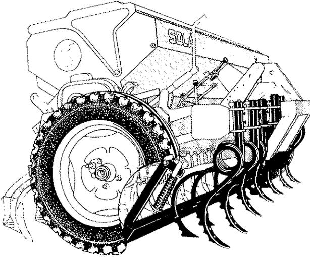
Las máquinas SUPER 784/R están preparadas para acoplarles un CULTIVADOR de prelaboreo, en cuyo caso el acoplamiento al tractor se efectúa mediante un ENGANCHE AUTOMÁTICO que enclava simultáneamente los tres puntos de conexión.
