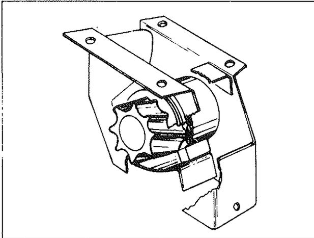
El rodillo acanalado sacagrano es de dentado helicoidal ofreciendo la máxima regularidad de siembra. El grano es acompañado al exterior, no forzado ya que el amplio paso del fondo, de tipo sifón, impide la rotura de granos.
