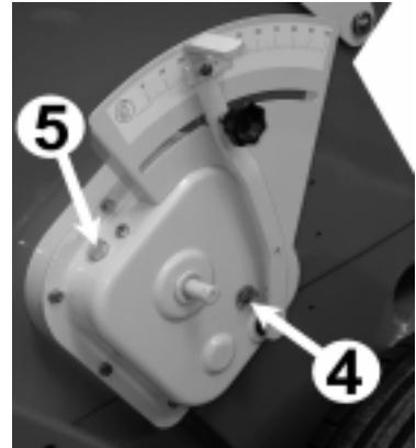
Controlar el nivel de aceite del variador a través de la mirilla (4, fig. 31) y si es necesario completar con aceite SAE 30 por el tapón (5, fig. 31)
