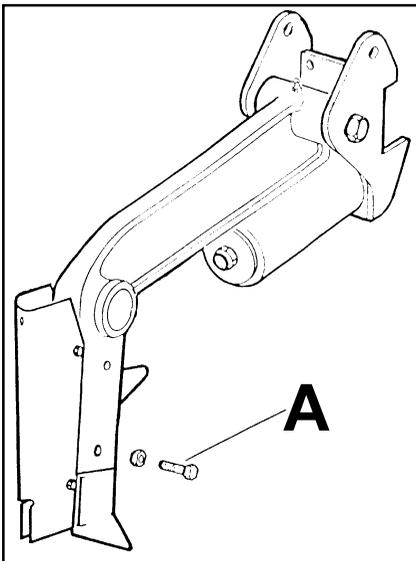
Todas las cuchillas están construidas con un material de altísima resistencia al desgaste. Su vida útil depende en gran manera de la dureza del suelo y de su textura y composición abrasiva. Es importante ir vigilando el estado de las punteras y sustituir las por unas nuevas cuando presente un desgaste acusado que podría modificar la profundidad de siembra. Para cambiarlas, basta soltar el tornillo -A, fig. 23- y sustituir la antigua por una nueva
