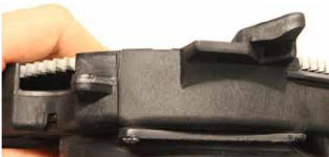
3. Per verificarlo, tenere il disco piatto contro la piastra centrale dell'unità. Il numero di lame di regolazione necessarie si determina aggiungendo o togliendo lame in modo che il disco si trovi all'interno dei piani inferiore e superiore. Il disco dell'erogatore deve essere controllato in almeno due posizioni per determinare il numero finale di lame. Ruotare di 180 gradi per verificare.
