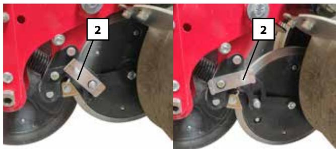
\* Ruota di compressione seme; posizione di lavoro e di esclusione.
