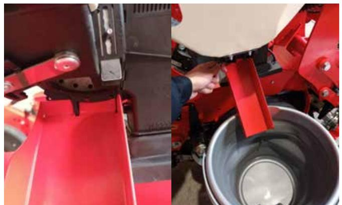
2. Con il flume in posizione, aprire la serranda di scarico tirandola leggermente e ruotandola verso sinistra. Non tirare troppo l'aletta per evitare di deformare la molla di chiusura e di non chiudere correttamente l'aletta.
