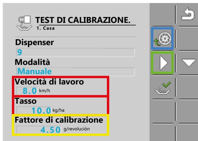
6. Per eseguire il test, è necessario tenere premuto il pulsante di calibrazione. È possibile utilizzare il pulsante di calibrazione sul display (blu) o il pulsante di calibrazione sull'unità di semina. Tenere premuto il pulsante di calibrazione fino a raggiungere un minimo di 0,060 kg di valore calcolato.
