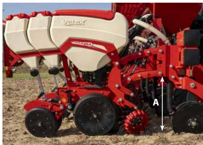
1. Con la macchina agganciata al trattore, lasciare che la macchina poggia leggermente sul terreno, in modo che le ruote di supporto siano a contatto con il terreno senza peso.
