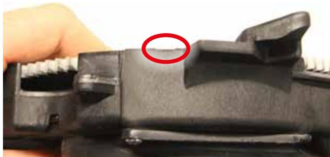
3. Pour le vérifier, maintenez le disque à plat contre la plaque centrale de l'appareil. Le nombre de lames de réglage nécessaires est déterminé en ajoutant ou en retirant des lames de manière à ce que le disque se trouve dans les plans inférieur et supérieur. Le disque du doseur doit être vérifié dans au moins deux positions pour déterminer le nombre final de lames. Tournez-le de 180 degrés pour le vérifier.
