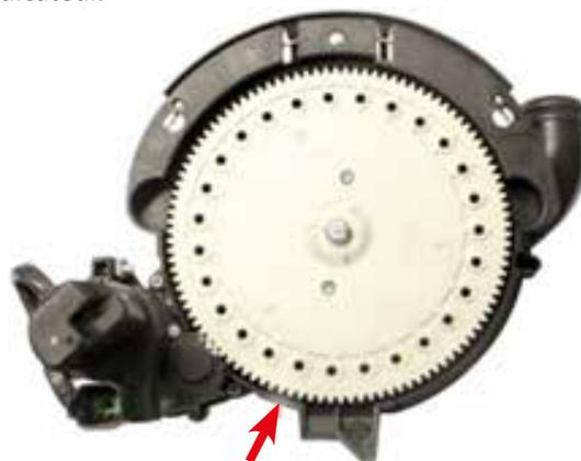
2. Observez la surface du disque par rapport au doseur. La face extérieure du disque doit se trouver entre les plans inférieur et supérieur, comme le montrent les flèches ci-dessous.
