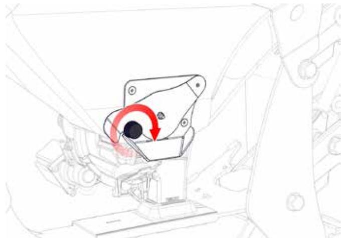
6. Monter le canal de vidange fourni avec la machine. La bride du canal doit s'insérer dans la fente correspondante du doseur.
