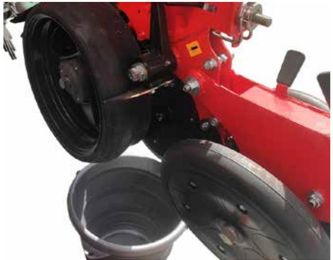
2. Remplissez la trémie avec le produit à appliquer et placez le godet de calibrage.
