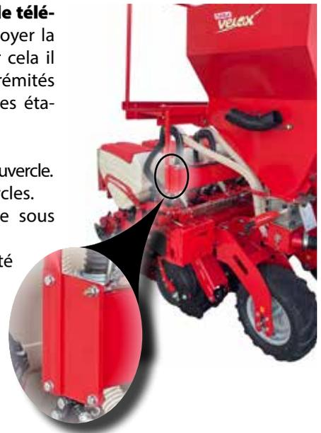
Pour les **modèles PF et PV**, vous devez nettoyer les buses disponibles sur la machine, à savoir une buse centrale et une buse sur chaque pièce repliable.
