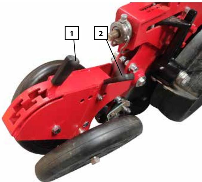
\* Ajuster les roues de recouvrement
