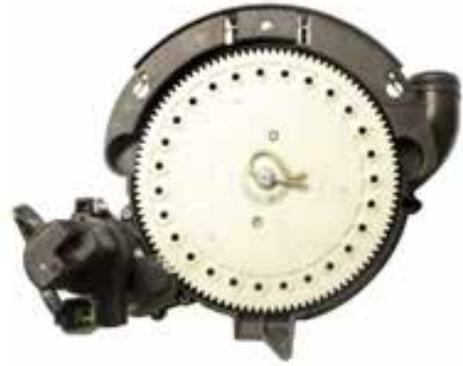
5. La dernière étape de l'installation du kit de cultivateur consiste à placer le singulateur dans le boîtier du doseur. Insérez d'abord la base du singulateur dans le clip inférieur, puis appuyez sur le clip supérieur. Veillez à ce que les côtés supérieur et inférieur du singulateur soient alignés avec les languettes à ressort. Vous devez vous assurer que le singulateur est bien en place pour garantir un lien correct du doseur lors de l'assemblage du couvercle et du boîtier.
