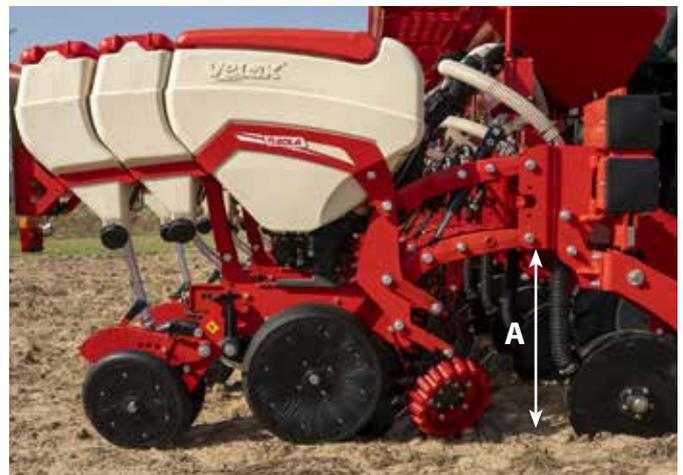
1. Lassen Sie die an den Traktor angehängte Maschine leicht auf dem Boden stehen, so dass die Stützräder den Boden ohne Gewicht berühren.
