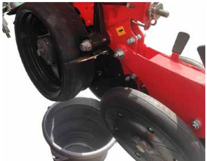
2. Füllen Sie den Trichter mit dem auszubringenden Produkt und setzen Sie den Kalibrierungseimer ein.
