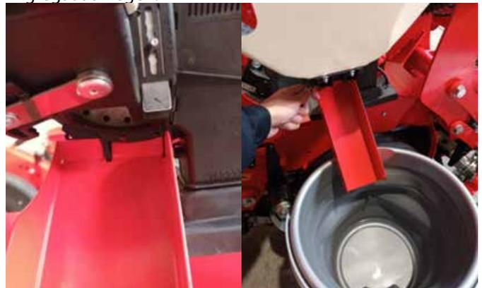
2. Öffnen Sie bei eingesetztem Gerinne die Abflussklappe, indem Sie sie leicht ziehen und nach links drehen. Ziehen Sie die Klappe nicht zu weit auseinander, da dies zu einer Verformung der Schließfeder führen kann und die Klappe nicht richtig schließt.
