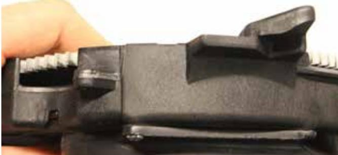
3. Um dies zu überprüfen, halten Sie die Scheibe flach gegen die Mittelplatte des Geräts. Die Anzahl der erforderlichen Einstellklingen wird durch Hinzufügen oder Entfernen von Klingen bestimmt, so dass sich die Scheibe innerhalb der unteren und oberen Ebene befindet. Die Spenderscheibe muss in mindestens zwei Positionen geprüft werden, um die endgültige Anzahl der Klingen zu bestimmen. Drehen Sie sie zur Überprüfung um 180 Grad.
