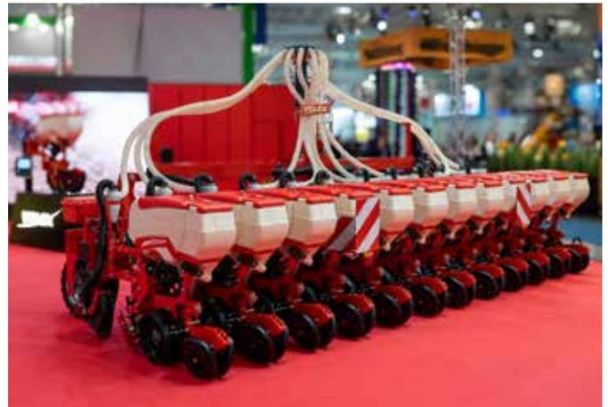
\* Verteilerkopf mit Düngerrohren
