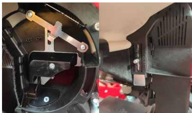
Der Dämpfer hat 4 Positionen (1,2,3,4) und kann bei Bedarf auch entfernt werden.
