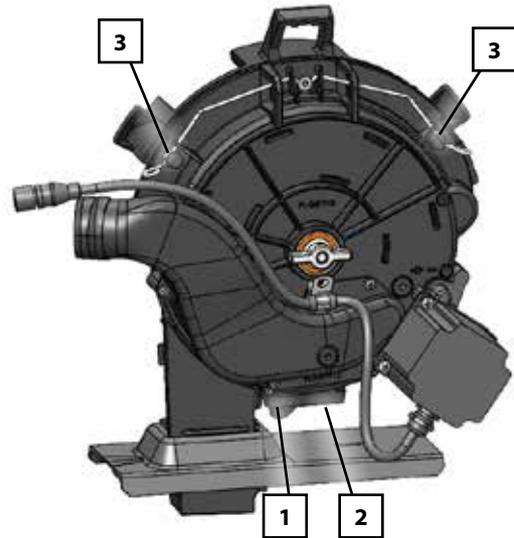
8. Las dos mitades del dosificador están correctamente unidas cuando los resortes de retención (1) están completamente acoplados con los postes de retención de la carcasa. Asegúrese de mantener el singulador presionado en la carcasa para que encaje correctamente en el disco dosificador.
