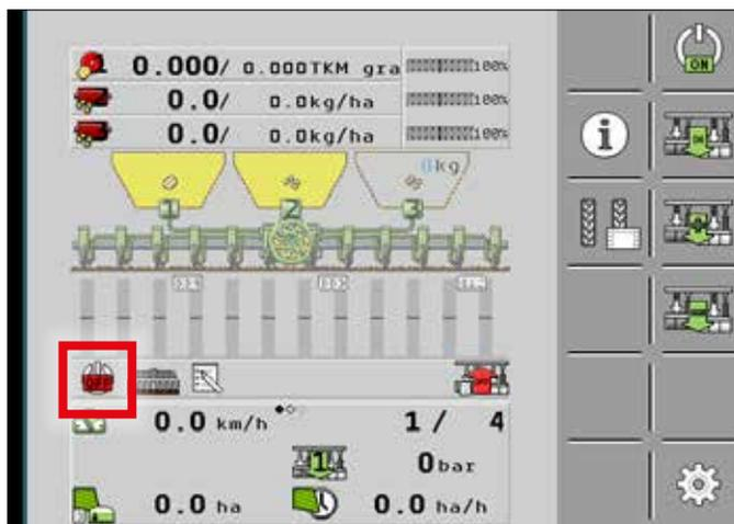
Con la aplicación encendida (ON), se actuará sobre el circuito hidráulico conectado en el distribuidor de la sembradora, en la pantalla se puede visualizar su estado (recuadro en ROJO).
