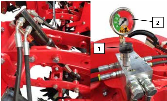
\* Cilindro hidráulico de presión de los cuerpos y válvula de regulación.
