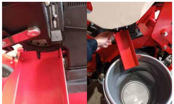
2. Con la canal colocada, abrir la compuerta de vaciado tirando ligeramente de ella y girando hacia la izquierda. No separar en exceso la compuerta ya que podría deformar el muelle de cierre y en consecuencia de ello, después no cerraría bien.
