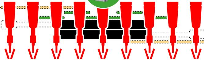
Para regular la máquina deberá actuar sobre los **6 tope de apertura entre filas (A)** a la distancia deseada que marquen las astas de los elementos (en AMARILLO y VERDE). Para regular la distancia entre las hileras proceder como se indica a continuación:
