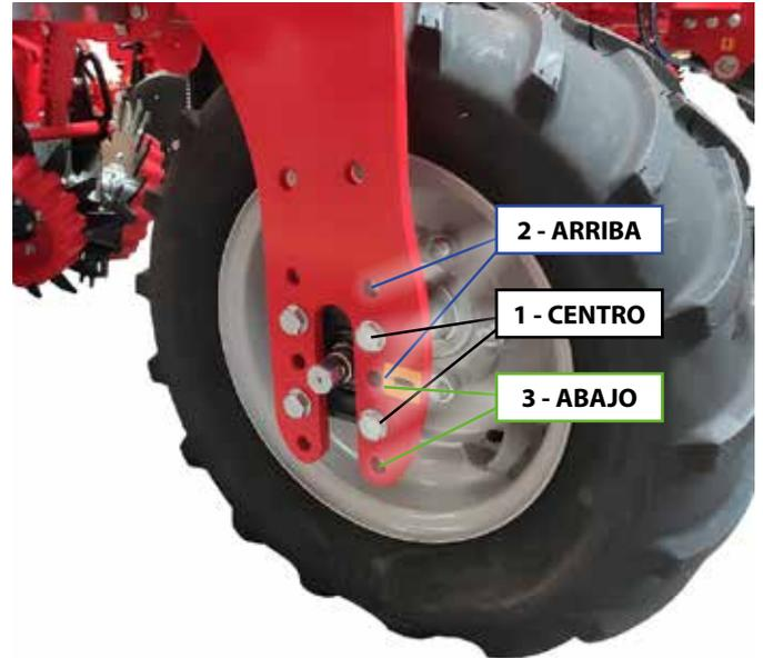
Para comprobar la posición correcta de las ruedas de apoyo es necesario medir la distancia entre el suelo y el soporte del elemento. La distancia correcta está entre 50 y 52 cm (A) en condiciones de siembra en campo.
