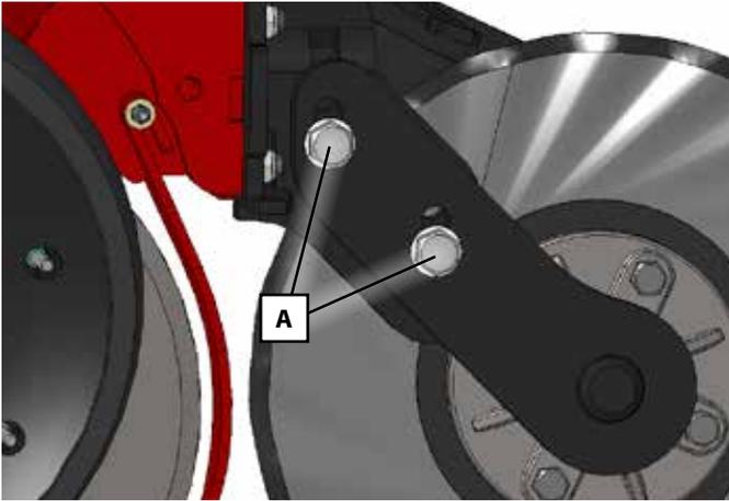
Para regular la profundidad de los discos turbo, es necesario actuar sobre los tornillos (A). Las posiciones en profundidad son las de la tabla siguiente:
