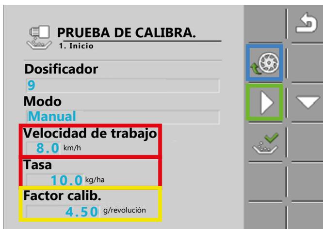
6. Para hacer la prueba se tiene que mantener pulsado el botón de calibración. Se puede utilizar la tecla de calibrado del display (en azul) o el botón de calibrado ubicado en el cuerpo de siembra. Mantener pulsado el botón de calibración hasta un mínimo de 0.060 kg de valor calculado.
