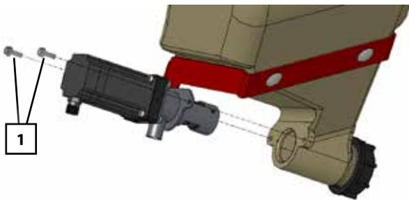
En caso de obstrucción, desmontar los tornillos de fijación (1), sacar el dosificador de sinfín y limpiar la obstrucción.
