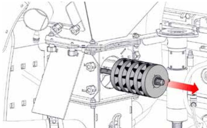
5- Montar el número de sectores necesarios según la dosis deseada. Para modificar la configuración de los sectores debe sacar un anillo seeger, montar los sectores deseados y volver a colocar el anillo seeger.
