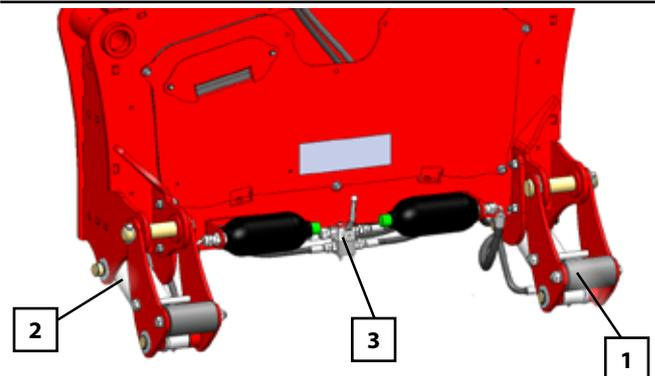
Con el equipamiento de la transmisión de peso del tractor es posible alcanzar la presión máxima de los cuerpos de siembra. Se puede transmitir hasta 1000 kg de peso desde el tractor a la barra de siembra.
