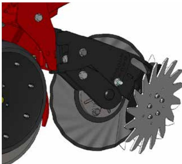
El conjunto de disco turbo abridor y de estrellas limpiadoras para disco turbo está especialmente indicado para condiciones de siembra sin laboreo (siembra directa).
