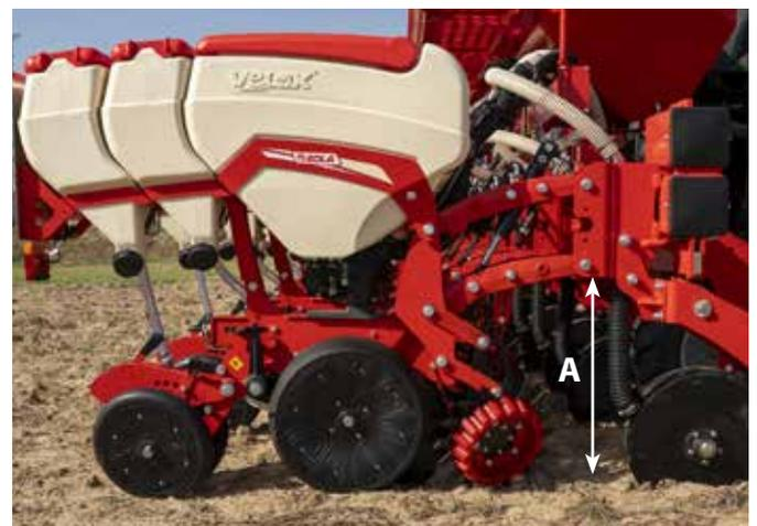
1. Con la máquina enganchada al tractor, dejar la máquina ligeramente apoyada en el suelo, justo que las ruedas de apoyo contacten con el suelo sin cargar peso.
