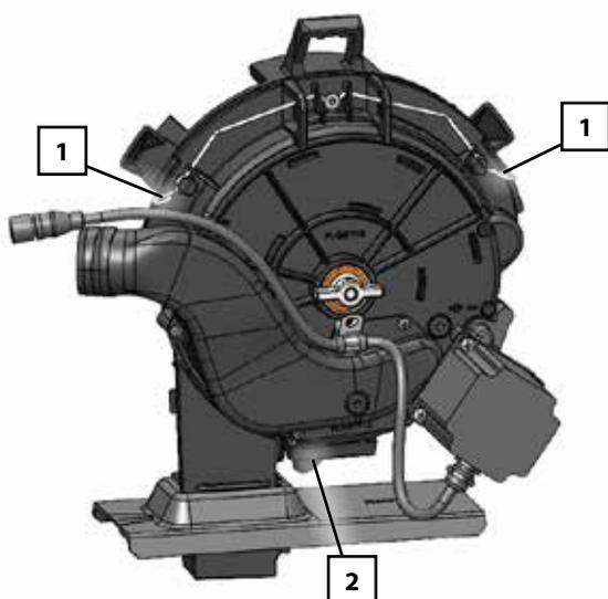
La tapa del dosificador contiene el disco y la rueda eyectora. El singulador se ensambla en la otra mitad opuesta del dosificador que está fijada a la tolva de semillas y que llamamos carcasa.
