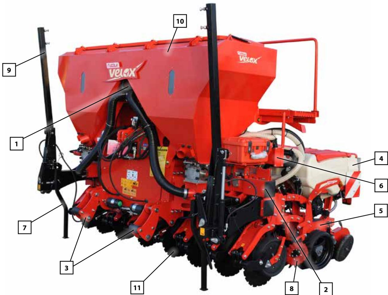
**1-** Ventilador de soplado para fertilizante.
