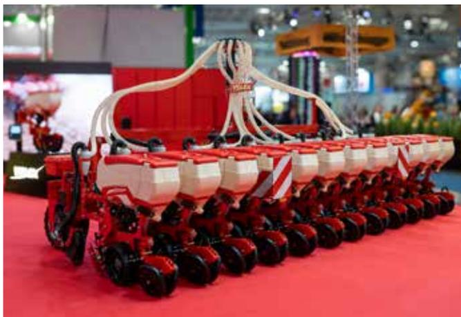
\* Cabezal de distribución con tubos de fertilizante
