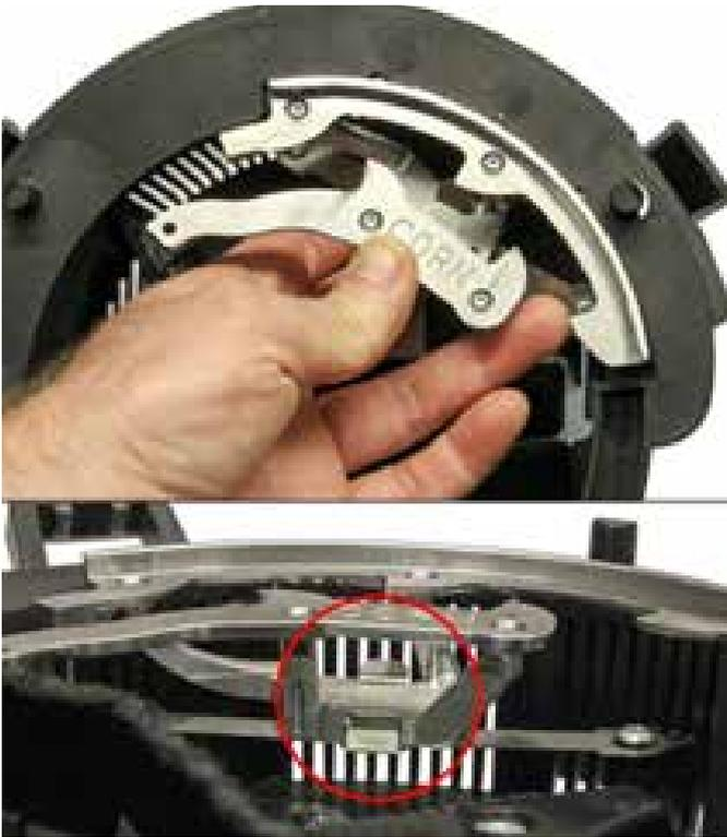
6. Para quitar los componentes del dosificador para reemplazarlos, retire las piezas de la misma manera que se instalaron en los pasos del 1 al 5. Para quitar el singulador, tire hacia atrás de la lengüeta de liberación y saldrá.
