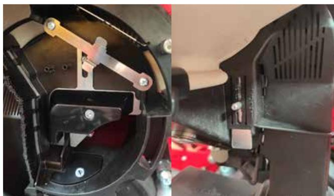
La compuerta tiene 4 posiciones (1,2,3,4) o incluso se puede extraer si es necesario.
