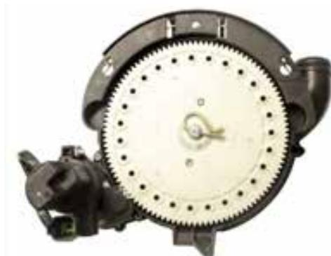
5. El paso final de la instalación del kit de cultivo es colocar el singulador en la carcasa del dosificador. Inserte primero la base del singulador en el clip inferior y presione en el clip superior. Asegúrese de que tanto el lado superior como el inferior del singulador estén al ras con las lengüetas del resorte. Debe asegurarse de que el singulador esté completamente asentado para garantizar una conexión adecuada del dosificador al ensamblar la cubierta y la carcasa.
