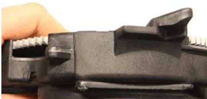
3. Para comprobarlo, mantenga el disco plano contra la placa central de la unidad. El número de láminas de ajuste necesarias se determina añadiendo o quitando láminas para que el disco esté dentro de los planos inferior y superior. El disco del dosificador debe verificarse en al menos dos posiciones para determinar el recuento final de láminas. Gire 180 grados para la verificación.
