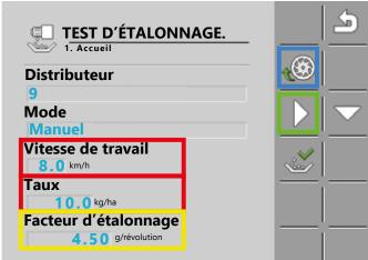
**6.** Pour effectuer le test, il faut appuyer sur la touche de calibrage et la maintenir enfoncée. Vous pouvez utiliser le bouton d'étalonnage sur l'écran (bleu) ou le bouton d'étalonnage sur l'élément semeur. Appuyez sur la touche d'étalonnage et maintenez-la enfoncée jusqu'à ce qu'un minimum de 0,060 kg de la valeur calculée soit atteint.
