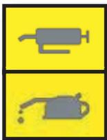
Les parties de la machine portant les symboles de lubrification et de graissage doivent être maintenues en bon état et bien graissées. Consultez la section 9.2 POINTS DE GRAISSAGE ET DE LUBRIFICATION.
