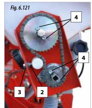
**2-** Détendez la chaîne en agissant sur l'écrou du tendeur à l'aide d'une clé (2, Fig. 6.121). Pour faciliter l'opération, maintenez la vis du tendeur (3, Fig. 6.121) à l'aide d'une autre clé (Fig. 6.122).
