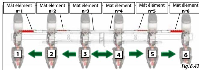
Pour régler la machine sur **6 RANGS** à 70, 75 ou 80 cm, il faut :
