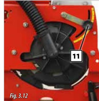
Pour chaque type de graine, il faut utiliser le disque de semis (2, Fig. 3.8) le plus adapté. En effet, la taille de la graine, l'espacement requis, etc. réclament un disque spécifique doté d'un nombre donné d'alvéoles pour contrôler l'espacement du semis. De plus, les alvéoles doivent correspondre à la taille d'une graine.
