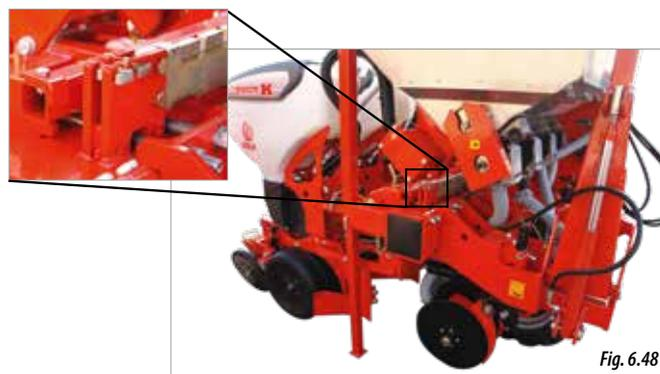
Pour régler la machine sur **6 RANGS** à 70, 75 ou 80 cm, il faut :
