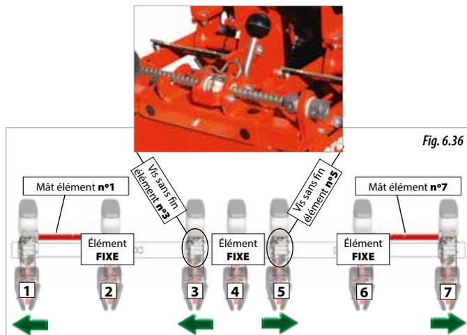
Pour régler la distance entre les éléments, agissez sur les butées d'ouverture des mâts (A, Fig. 6.38), comme indiqué ci-dessous :
