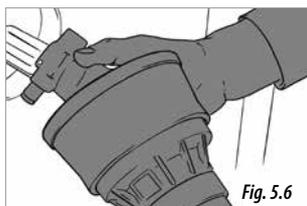
la goupille de sécurité enfoncée, lâchez la goupille et faites reculer le cardan jusqu'à entendre un clic. Le clic permet de savoir que la goupille est bien bloquée dans son logement.
