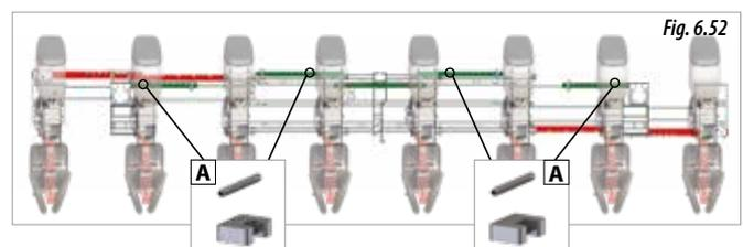
Pour régler l'écartement, positionnez les **6 butées d'ouverture entre rangs** (A, Fig. 6.53) à la distance voulue indiquée par les mâts des éléments (mâts rouges, Fig. 6.52). Pour régler l'inter-rang, procédez comme suit :
