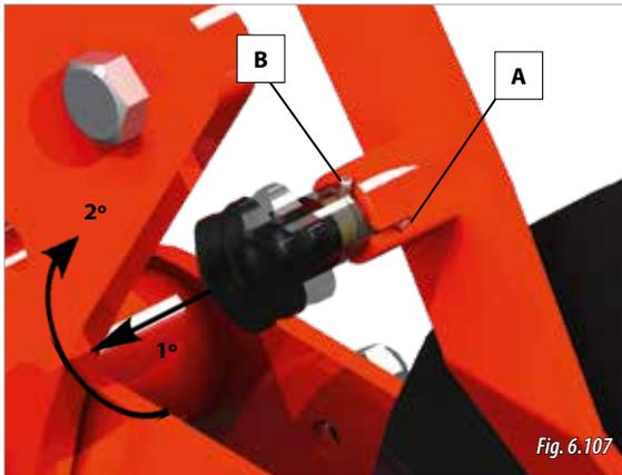
Pour débloquer l'élément de la position de débrayage, tirez sur la sécurité (1, Fig. 6.106) et tournez la goupille pour l'amener en position B (Fig. 6.107).
