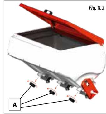
Pour **VIDER** les trémies à engrais, ouvrez les bouchons situés en bas des trémies (A, Fig. 8.2).
