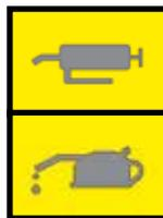
Les parties de la machine portant les symboles de lubrification et de graissage doivent être maintenues en bon état et bien graissées. Consultez la section 9.2 POINTS DE GRAISSAGE ET DE LUBRIFICATION.
