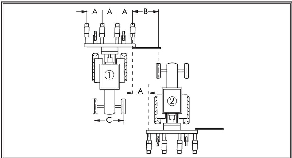
Esta regulación permite mantener entre la carrera de ida 1 y la de vuelta 2 la misma distancia entre líneas A.
