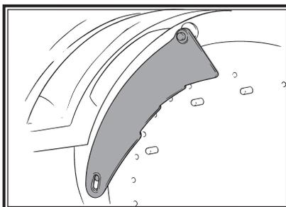
A continuación volver a colocar la tapa y fijarla con las 2 palomillas.
