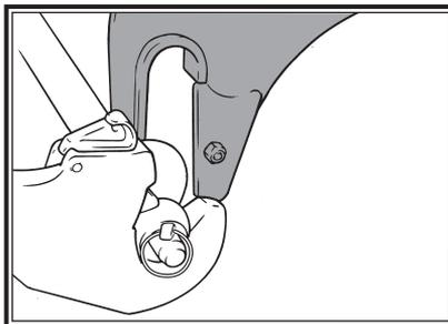
Si la máquina no lleva barra de enganche, montar primero las bolas en los bulones de enganche de la máquina y seguidamente posicionar los brazos del tractor en dichas bolas.
