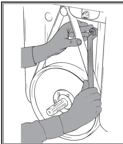
Tensar la cinta de transmisión mediante el tornillo superior.
