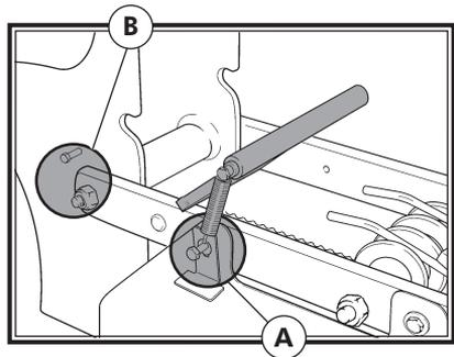
Para desenganchar el elemento, volver a situar el muelle en el punto «A», y seguidamente bajar la máquina hasta el suelo, apoyando el elemento a desenganchar sobre un taco de madera de unos 20cms.
