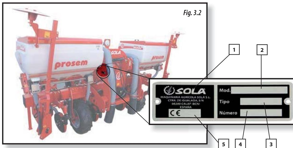
Todas las máquinas llevan una PLACA DE IDENTIFICACIÓN en el tripuntal, donde especifica:
