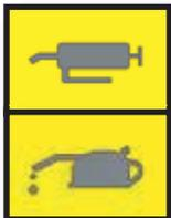
Mantener en buenas condiciones y engrasadas las partes de la máquina donde hayan estos símbolos de lubricación y engrase. Véase apartado 9.2 PUNTOS DE ENGRASE Y LUBRICACIÓN.
