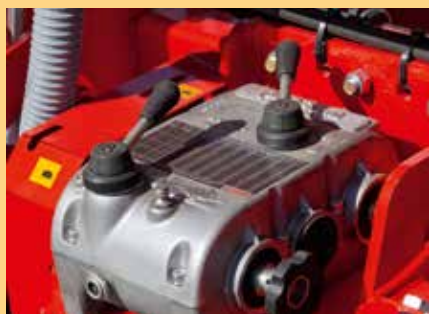
Przekładnia dystansowa NORTON (seryjnie dla siewników na ramach sztywnych >7 rzędów, na ramach teleskopowych i z układem Variant). Opcjonalnie dostępna dla pozostałych modeli.
