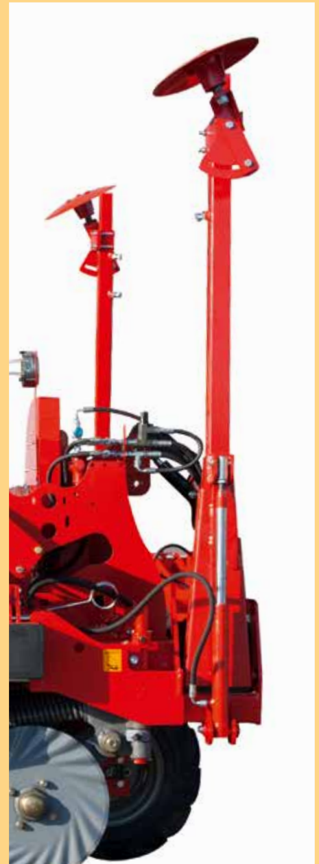
Znaczniki przejazdów składane hydraulicznie, talerzowe, z zabezpieczeniem śrubowym.
