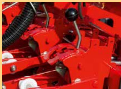
Regulowane ustawienie docisku na sekcji wysiewającej PROSEM K.
