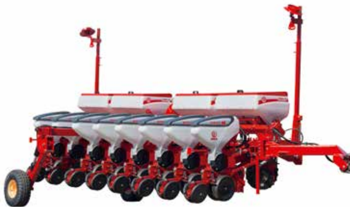
Dzięki wózkowi wbudowanemu wzdłuż ramy sztywnej, uzyskuje się szerokość transportową 3m.
