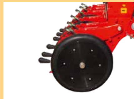
Tylne bloki ugniatające z kołami ustawionymi w kształcie „V” o szerokości 1” lub 2”, regulowane.
