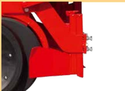
Отбрасыватель комьев и прорезной нож, регулируемый по высоте.
