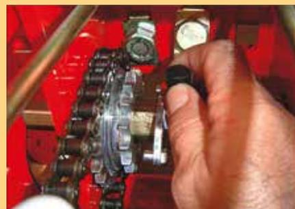
Ручной выключатель посева для каждой секции.
