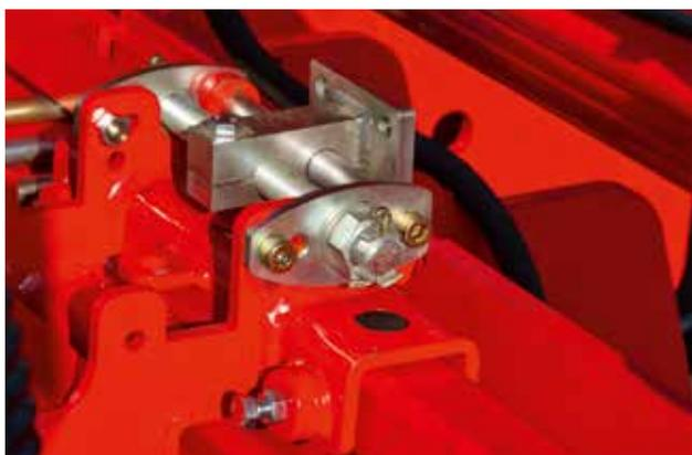
Система регулировки расстояния по миллиметрам между высевными секциями VARIANT PLUS.
