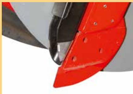
Башмак литой и высевной трубопровод с нержавеющей наконечником.
