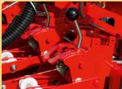
Регулятор давления секции на почву.
