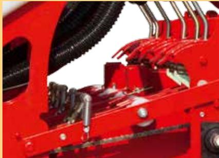
Рычаг для отключения секции.
