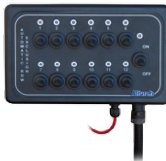
Электрический выключатель секций с кабины трактора.
