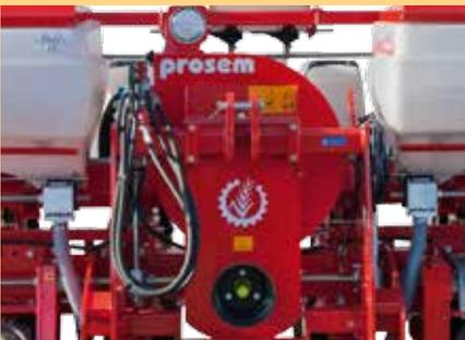
Вентилятор и вакуумметр.
