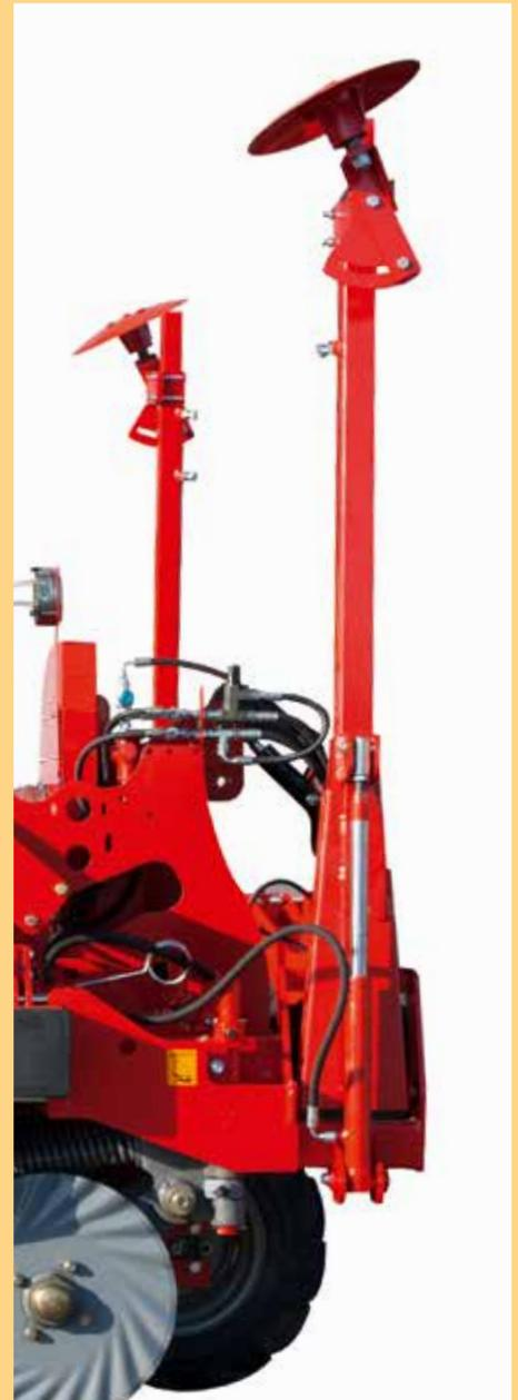
Дисковые гидравлические маркёры с предохранителями.
