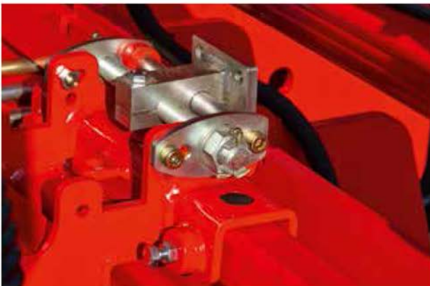
VARIANT PLUS rendszer a sortávolság milliméteres pontosságú beállításához.
