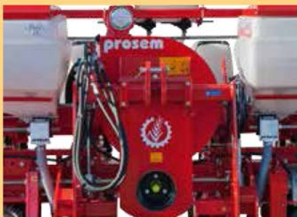
Nagyteljesítményű ventilátor és szívónyomás mérőóra.
