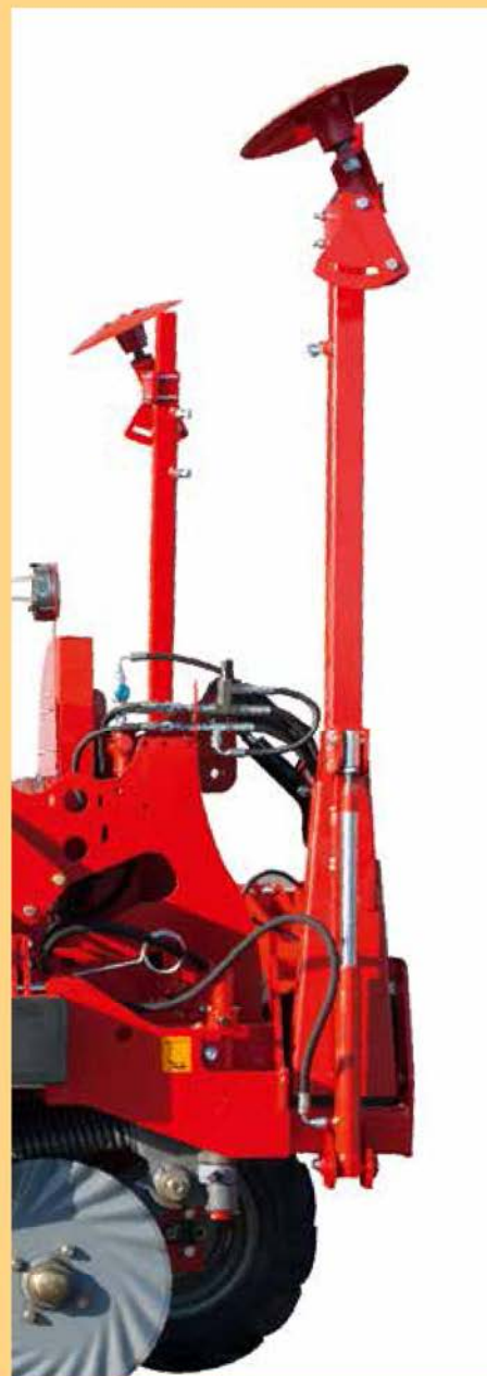
Hidraulikusan mozgatott nyomjelző tárcsák lezuhanás gátló szeleppel.
