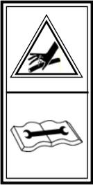
Possibilité de pénétration de fluide hydraulique à pression. Maintenir les conduites en bon état.
