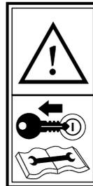
Arrêter le moteur du tracteur et éviter de le démarrer pendant les travaux d'entretien ou de réparation du semoir.
