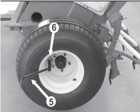
TROISIEME: on place le levier (5, fig. 21) dans le logement (6, fig. 21) de la roue gauche et on donne quelques tours à la roue jusqu'à ce que l'engrais commence à tomber. La machine TRI-294/R-ESP est livré sans le levier. Ainsi, les tours devront se faire à la main. On retire cet engrais et on commence à faire les tours selon le dessin ci-dessous:
