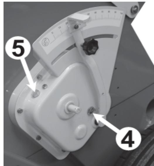
Vérifier le niveau de l'huile du variateur par l'ouverture (4, fig. 39) y si c'est nécessaire on doit le remplir avec de l'huile SAE 30 par le bouchon(5, fig. 39)
