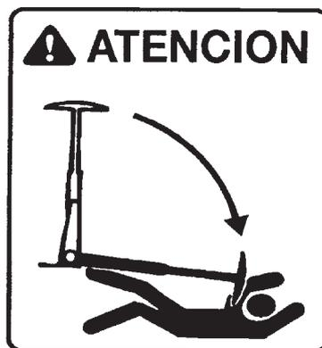
On ne doit pas se placer sous les traceurs ni dans son rayon d'action. **Danger de graves lésions.**
