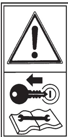
Arrêter le moteur du tracteur et éviter de le demarrer pendant les travaux d'entretien ou de réparation du semoir.
