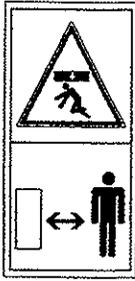
Danger d'écrasement si on travaille dessous la machine, on doit l'assurer pour éviter son écoulement. Danger de graves lésions.
