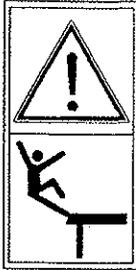
On ne doit pas monter sur l'échelle pendant la machine est en marche.
