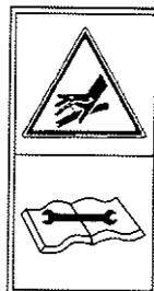
Posibilidad de penetración de fluido hidráulico a presión. Mantenga en buen estado las conducciones. Peligro de lesiones graves.
