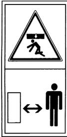
Danger d' écrasement si on travaille dessous la machine, on doit l'assurer pour éviter son croulement. Danger de graves lésions.
