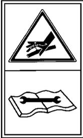
Mantenga en buen estado las conducciones hidráulicas. **Peligro de lesiones graves.**
