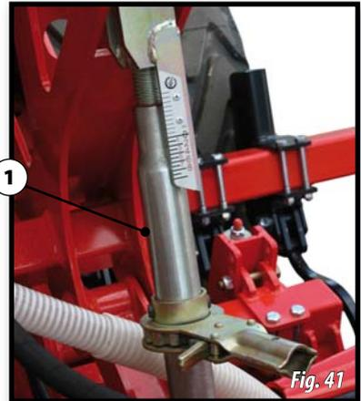
Después de la regulación, guardar el trinquete del husillo hacia el interior de la máquina.
