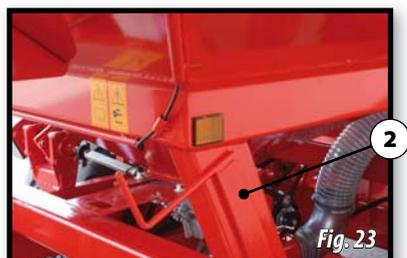
Coloque la maneta en el extremo de la tova y tire hacia adelante para retirar la lona de la tova.
