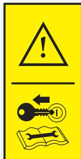
Pare el motor del tractor y evite que se arranque durante los trabajos de mantenimiento o reparación de la sembradora.
