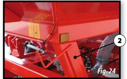
6- Coloque la maneta en el extremo de la tova y tire hacia adelante para retirar la lona de la tova.
