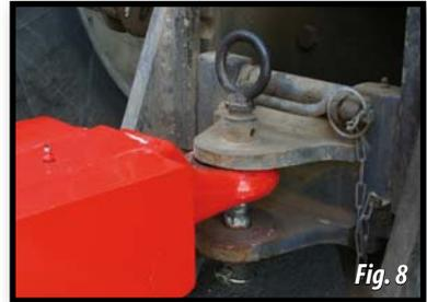
Una vez enganchada al tractor, la sembradora debe quedar en posición horizontal.
