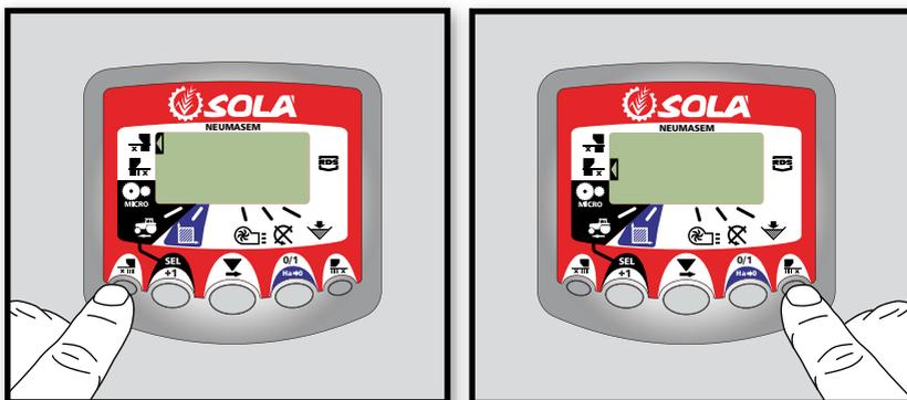
Para volver a la posición normal y abrir las salidas, volver a pulsar el botón
