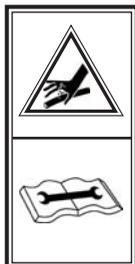
Posibilidad de penetración de fluido hidráulico a presión. Mantenga en buen estado las conducciones.
